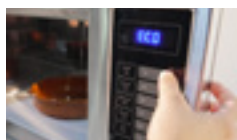
Dotykowy panel sterowania z wyświetlaczem LED, trzy poziomy mocy.
